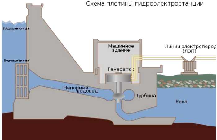
Схема плотины гидроэлектростанции
